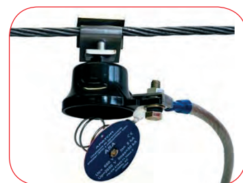
ASA surge arrester with disconnecter after MO-blocks have been damaged Überspannungsableiter Typ ASA mit einer Trennvorrichtung nach dem Auslösen (beschädigter Varistor)
